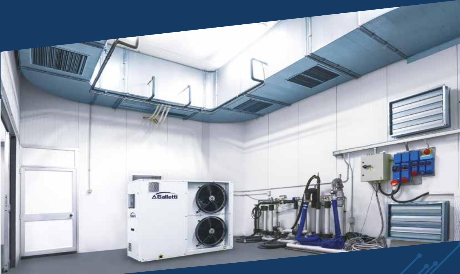
Il sistema di **misura e acquisizione** dati realizzato dal team R&D Galletti permette infine il monitoraggio dei principali parametri di funzionamento della macchina in prova e l'**acquisizione** dei dati una volta raggiunte le condizioni di stabilità previste dalle procedure di test standardizzate.
